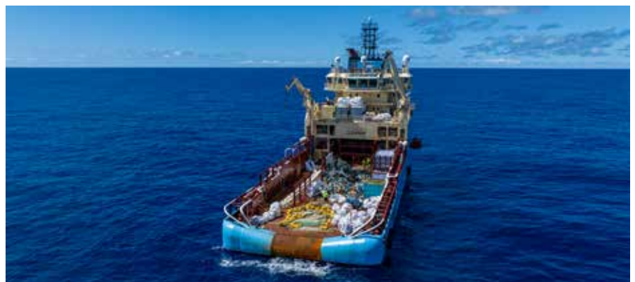
▲ Ude i bagbord ligger en del af de poser, der bruges som trawl til optag af havplastikken.
