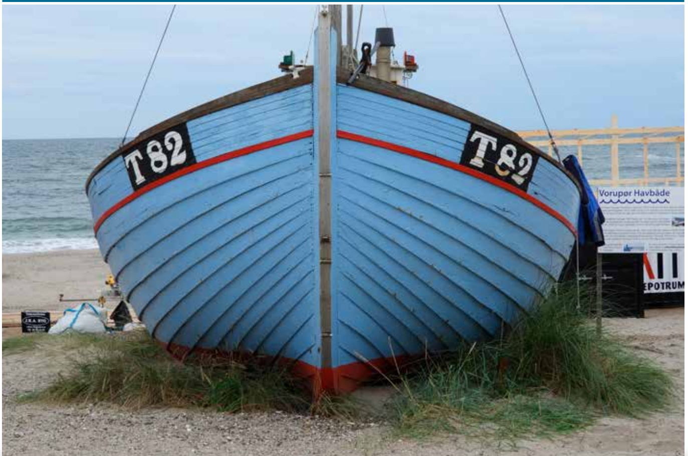
▲ Et fint eksempel på et klinkbygget fartøj er T82 "Tabor" bygget i Nr. Vorupør i 1947. Er i dag museumsskib for Vorupør Havbåde.
