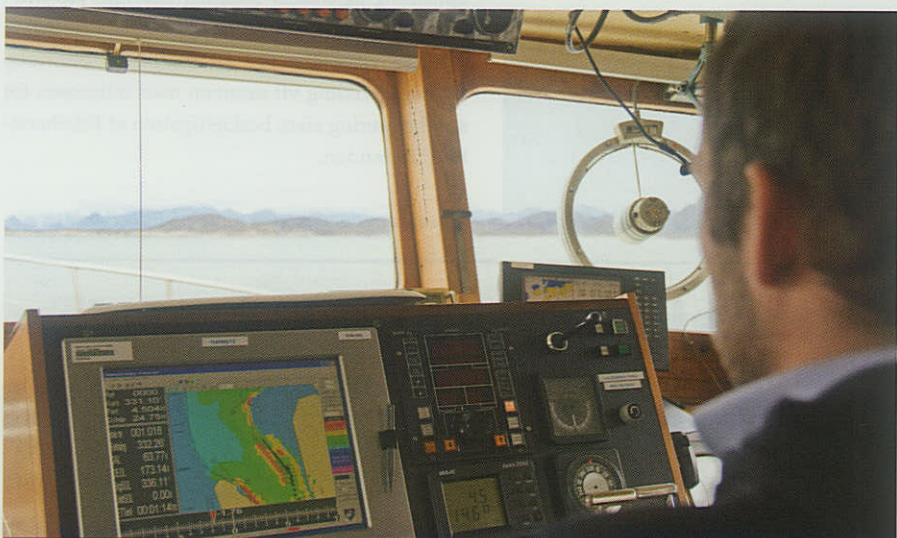
Tekniker Jesper Dahl står ved roret og følger skibets kurs i et elektronisk søkort på en skærm foran ham. Dybderne fra ekkoloddet plottes øjeblikkeligt ind på kortet, en farve til hvert dybdeinterval.
