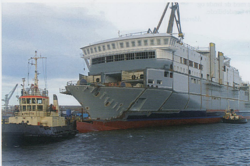
Den 211 meter lange og 30 knob hurtige Color Line færge "Super-Speed 1" under færdiggørelse ved værftet i Rauma, Finland. (Foto: Color Line).
