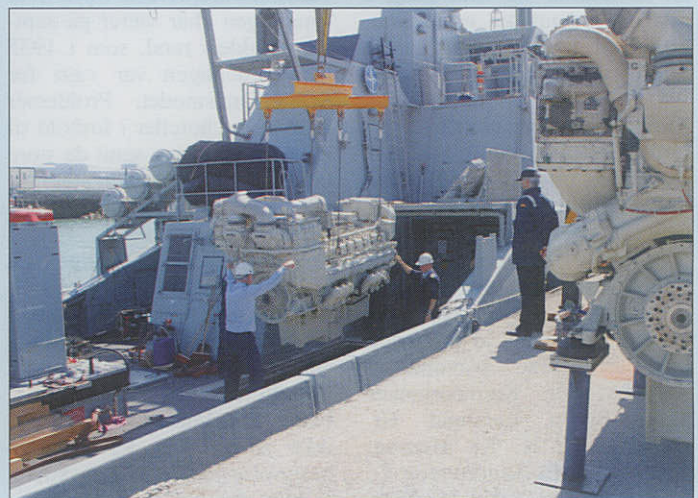
Motorskift på "Ravnen" i Naval Station Puntarles. 17 timer så var den motor klar.
