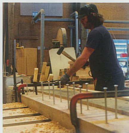
Skibstørmrer Jens Møller Martensen i færd med at montere egetræsklædningen på de svære spanter.
