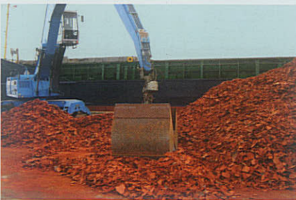
Skrukkede knuste teglsten fra Højslev Teglværk på vej til Holland, hvor de genopstår som tennisbanegranut.
