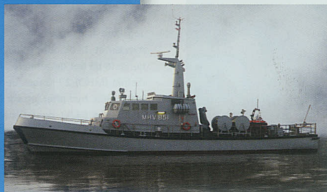
MHV 851-klassen (1 enhed) 113 tons displacement. 27,2-5,5-2,5 m. 13 knob.
