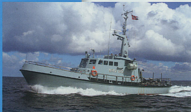
MHV 800-klassen (17 enheder) 85 tons displacement. 24-5,6-2 m. 13 knob.
