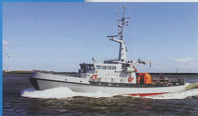
MHV 900-klassen (12 enheder) 113 tons displacement. 27,2-5,5-2,5 m. 13 knob.
