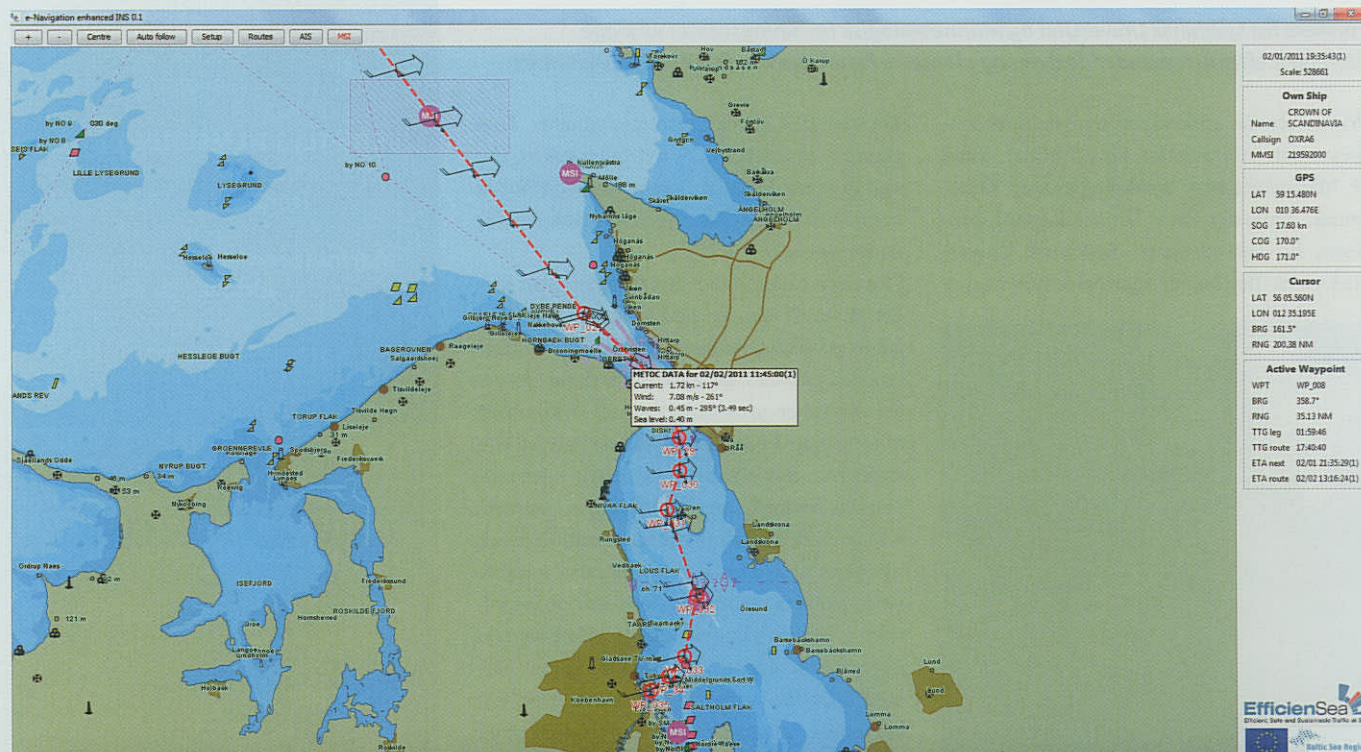
Et screenshot af ee-INS-displayet med de tjenester, der blev demonstreret på konferencen 'e-Navigation Underway'. På billedet ses METOC (meteorologiske og oceanografiske data på ruten) og MSI (Maritime Safety Information/Navigationsadvarsler). METOC-tjenesten blev brugt til at vise vejret på turen mellem København og Oslo.
