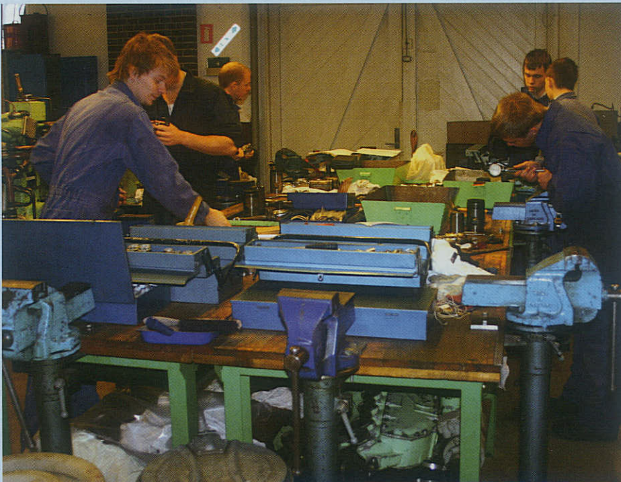
Tekniske officerer skal have praktisk kendskab til mekanisk bearbejdning, svejsning samt adskillelse og samling af motorer. Derfor gennemfører de et værkstedskursus, hvor disse færdigheder skabes
