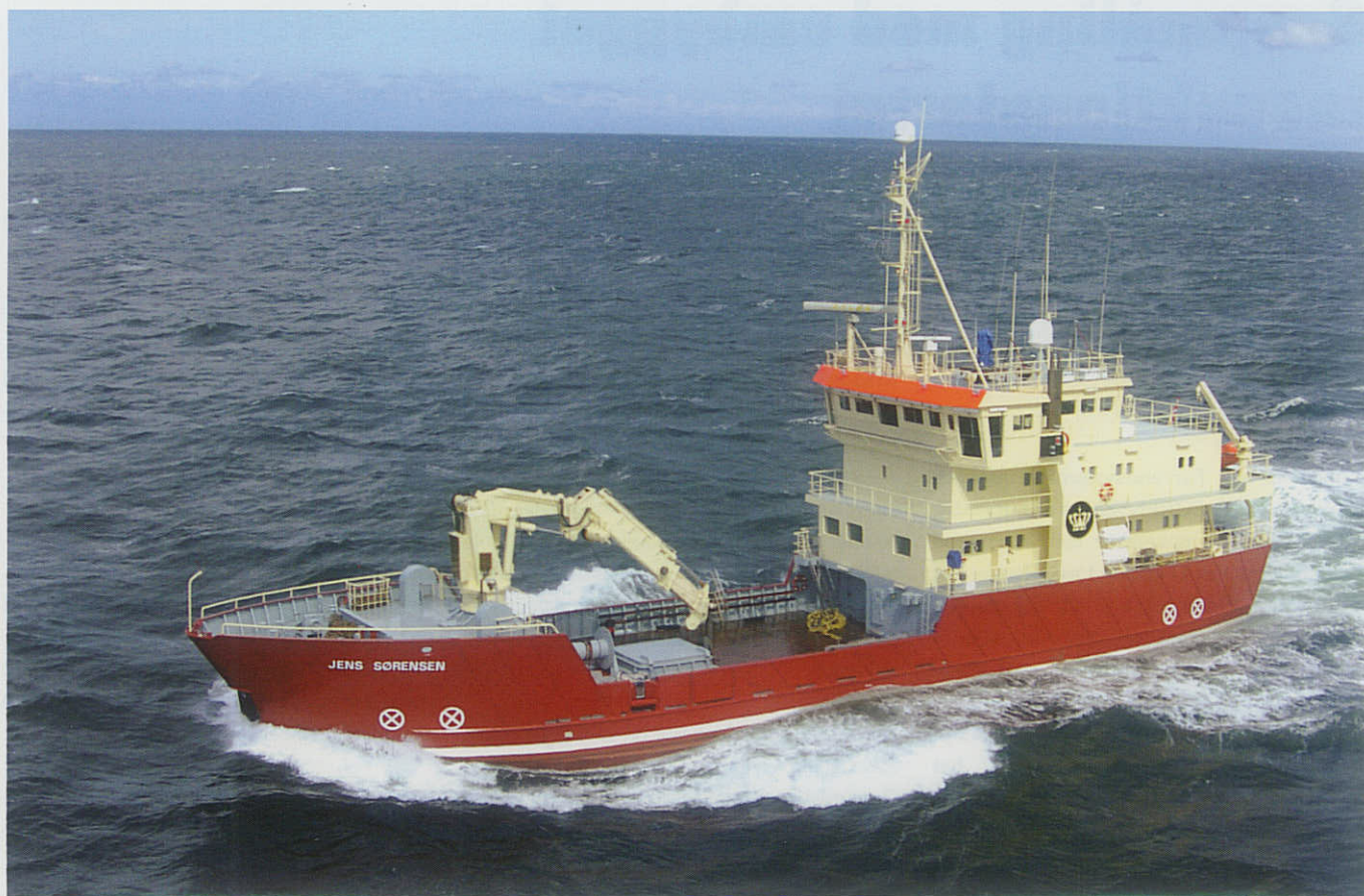
Inspektionsskibet JENS SØRENSEN er bygget om til også at være et søopmålingsskib. Det synlige tegn på ombygningen er, at skibets bæddæk er udvidet med ekstra mandskabskamre. (Foto: Ove Juul, Farvandsvæsenet).
