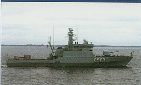
SØLØVEN (P 563, 1996). 420 ts. 54-9-3 m. 18 knob. Under ombygning til dykkertræningseskibe.
